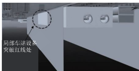
图 5 局部车站设备突破红线示意图
