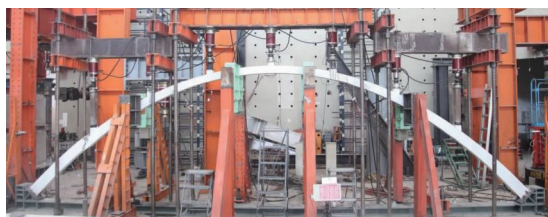
图 6 主拱缩尺模型试验
