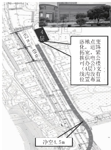
图9 B 匝道与天鹅湖北路净空 4.5 m 方案示意图
