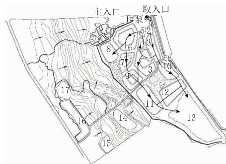
图5 河道取水流程示意图
