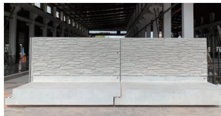
图1 预制装配式二级挡墙预制构件照片
