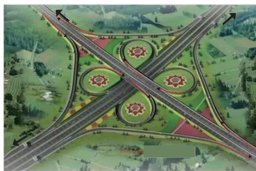
图1 全苜蓿叶立交主线进出车辆示意图
