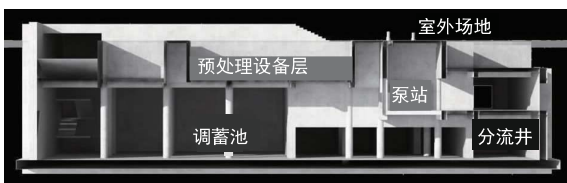
图8 南河地下构筑物合建示意图
