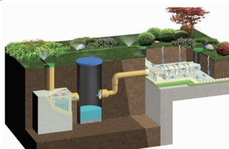
图1 种植顶板虹吸排水示意图
