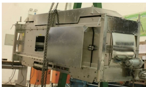
图 1 小型加速加载 MMLS3 试验机
