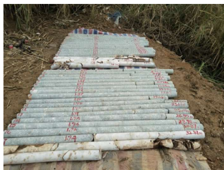
图3 右幅11#-3桩基1#孔、2#孔芯样图
