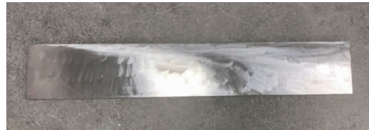
图5 除锈后的钢板
