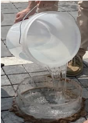
图10 现场透水系数测试
