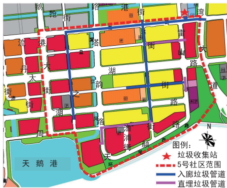
图2 5号社区垃圾气力输送系统总体方案
