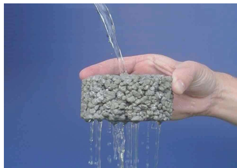
图2 透水混凝土空隙示意图
