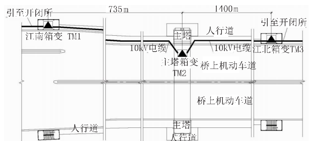
图 2 变电站平面布置图
