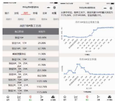
图6 施工页面吊杆信息
