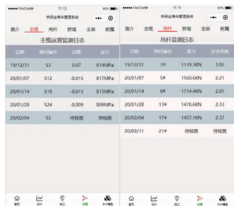
图7 主缆与吊杆实时监测
