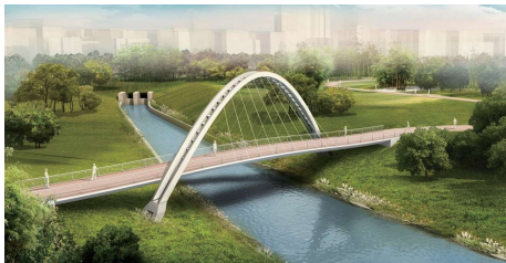
图1 钢箱斜跨拱桥效果图
