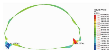
图 8 隧道剪力分布图
