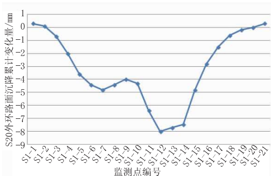
图10 S20外环路面沉降累计变化量与监测剖面S1关系曲线图
