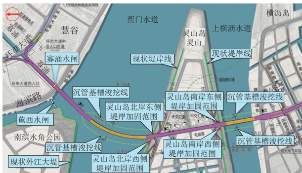
图 1 格构式地连墙护岸支护范围平面图
