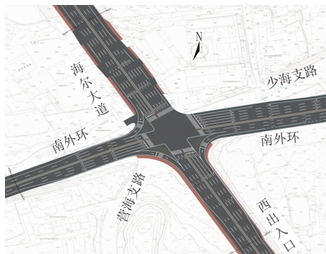
图2 改造后的4路交叉口平面图(方案一)
