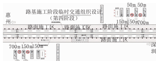
图 13 路面施工阶段临时交通组织设计(第四阶段)
