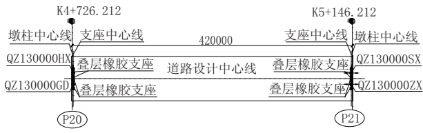
图4 420 m 联主桥约束体系(单位:mm)
