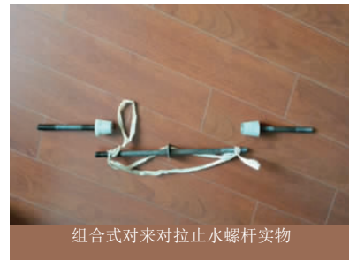
图2 组合式对拉螺杆结构实物图
