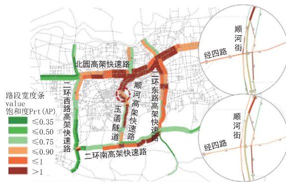
图 9 新增经一路下匝道前后地面道路交通运行状况对比
