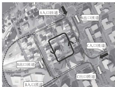
图3 地下环路外部出入口布置分析图
