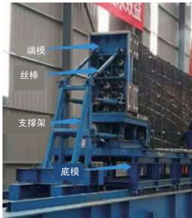
图 6 曲线简支梁端模
