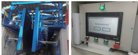
图4 曲线梁模板(侧模及可视化数控操作系统)
