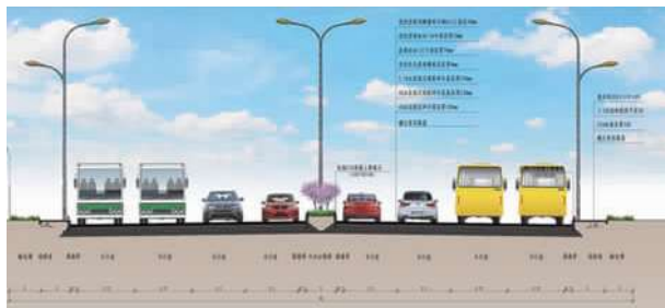
图3 渝黔复线进城通道标准横断面图
