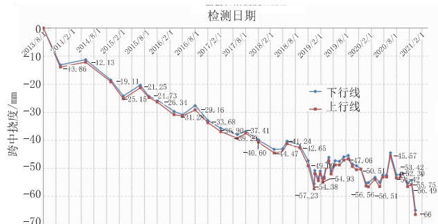
图 1 成桥后中跨跨中挠度变化
