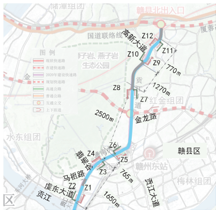
图4 赣南大道快速路(赣县段)出入口布置示意图
