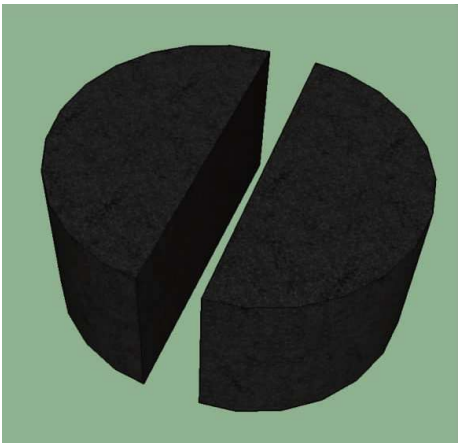
图 3 对称破坏马歇尔试样
