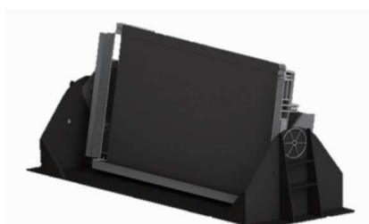
图 5 模具拆模起吊状态示意图
