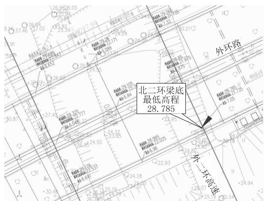
图12 下穿隧道平面图
