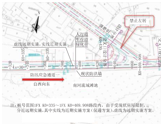
图 4 一次规划设计,分期实施的平面布置图
