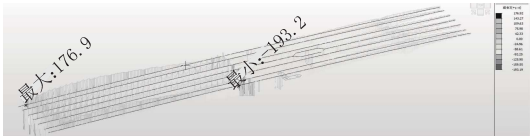
图 5 主梁纵梁下缘最大最小正应力图(单位:MPa)
