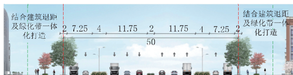
图 10 方案一标准横断面图(单位:m)
