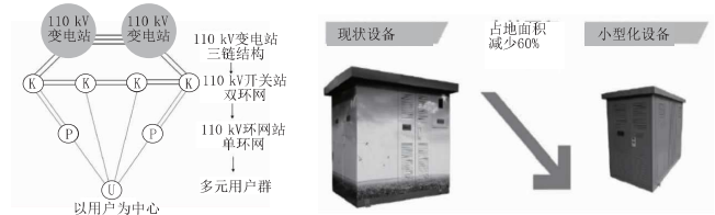
图4 “钻石型”配电网拓扑示意图和紧凑型智能箱变
