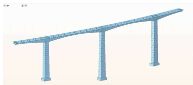
图 1 全桥有限元模型图
