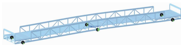
图 1 18.4 m+18.4 m 桁架梁空间杆系模型
