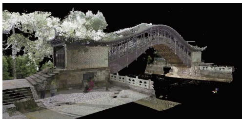
图4 渭源灞陵桥点云数据大范围去噪示例
