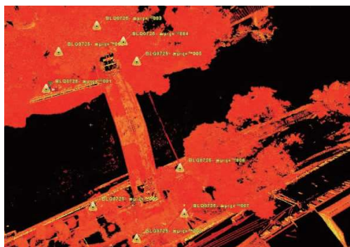
图2 渭源灞陵桥点云强度显示数据中扫描站点的分配图
