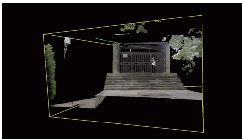
图5 渭源灞陵桥点云数据精细化去噪示例
