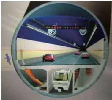
图 4 隧道盾构横断面示意图
