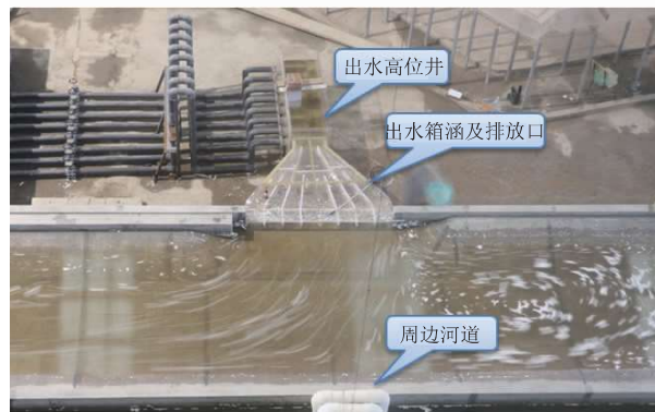
(b) 泵站出水系统水力模型
