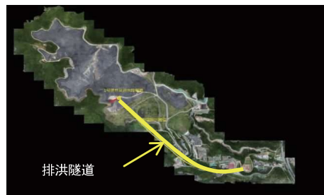
图 2 某填埋场竖井和排洪隧道示意图
