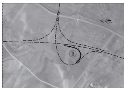
图 2 B 形单喇叭互通环形出口匝道
