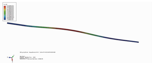
图 9 14 m 水深管道竖向变形
