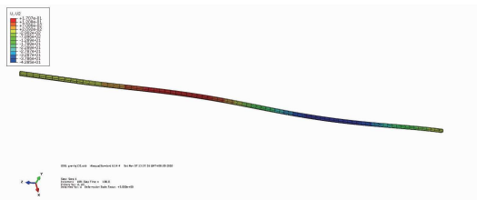
图 7 12 m 水深管道竖向变形
