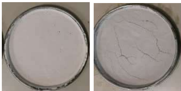
图4 矿粉黏性土快速测定(左,正常;右,偏高)
