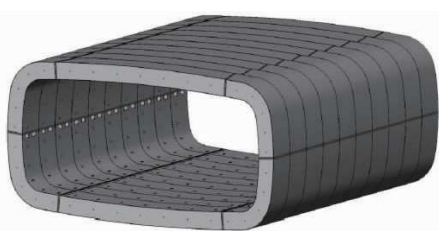
图 5 矩形盾构管片拼装
