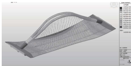
图 16 体系转换后全桥位移计算结果
