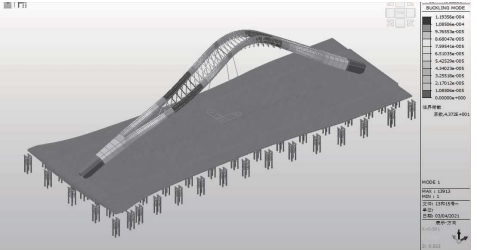
图14 拱肋在2组拉索固定时的屈曲分析计算结果
