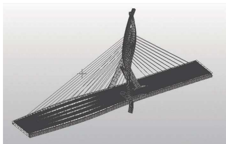
图9 主桥结构第2阶失稳模态
