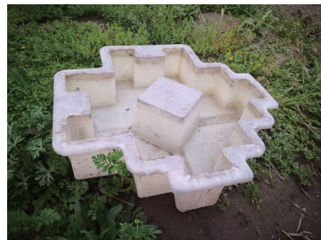
图 8 浇筑新型连锁块的塑料模具之实景
